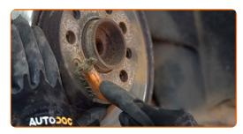
Lösen Sie die Befestigung der Bremsscheibe. Verwenden Sie Inbusschlüssel Nr. H5. Verwenden Sie einen Ratschenschlüssel.
