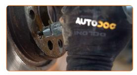
Entfernen Sie die Bremsscheibe.
