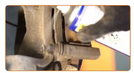
Lösen Sie die Befestigung der Sattelhalterung. Verwenden Sie Stecknuss Nr. E12. Verwenden Sie einen Ratschenschlüssel.
