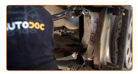
13 Entfernen Sie die Sattelhalterung.
