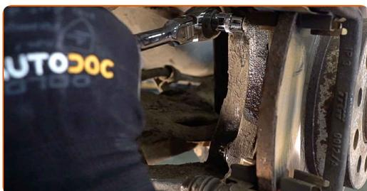
**13** Entfernen Sie die Sattelhalterung.
