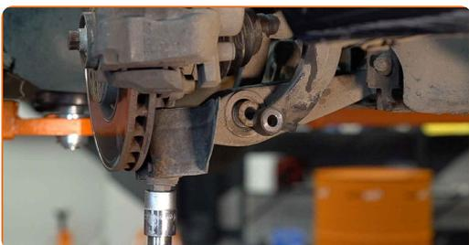
**43** Schrauben Sie das Befestigungselement ein, das die Stoßdämpfergabel mit dem unteren Querlenker verbindet. Verwenden Sie Stecknuss Nr. 21. Verwenden Sie ein Windeisen.
