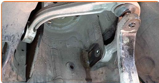
**26** Entfernen Sie den Arm. Benutzen Sie ein Brecheisen.
