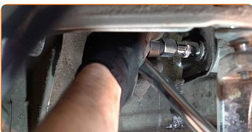
**25** Entfernen Sie die Befestigungsschrauben.
