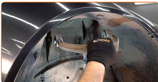
**27** Reinigen Sie die Montagebohrungen und die Gewinde des Querlenkers. Benutzen Sie eine Drahtbürste. Benutzen Sie WD-40-Spray.
