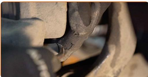
8 Trennen Sie den Stecker der Verschleißsensoren des Bremsbelags.
