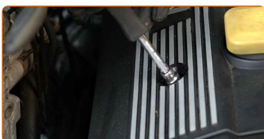
**7** Schrauben Sie die Öleinfüllschraube ab.
