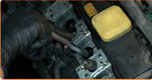
**18** Schrauben Sie die neuen Zündkerzen an und ziehen Sie diese fest. Verwenden Sie die Zündkerzennuss # 16. Verwenden Sie einen Drehmomentschlüssel. Ziehen Sie ihn mit 26 Nm Drehmoment fest.
