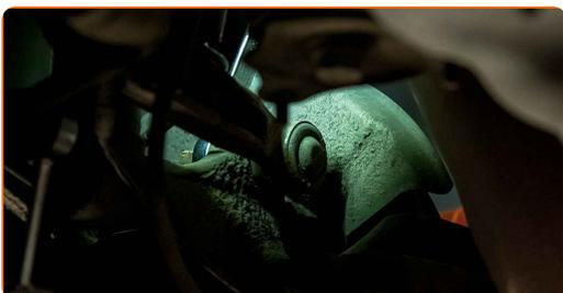
**13** Lösen Sie den Aufhängungsarm vom hinteren Achsschenkel.
