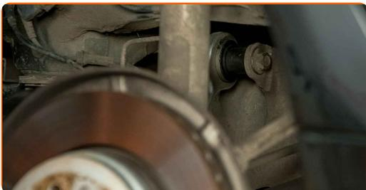
**20** Schrauben Sie die vordere Armbefestigung an. Verwenden Sie Ring-Gabelschlüssel Nr. 18 (2 Teile).
