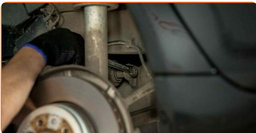
**11** Entfernen Sie die vordere Befestigung des Querlenkers. Benutzen Sie ein Brecheisen. Verwenden Sie einen flachen Schraubendreher.
