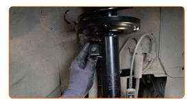
Ziehen Sie das Befestigungselement an, das die Druckstange mit dem Federbein verbindet. Verwenden Sie Ring-Gabelschlüssel Nr. 17. Verwenden Sie Stecknuss Nr. 18. Verwenden Sie einen Drehmomentschlüssel. Ziehen Sie ihn mit 55 Nm Drehmoment fest.
