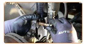
Bringen Sie die Befestigungsklammer des oberen Domlagers an. Verwenden Sie eine Wasserpumpenzange.
