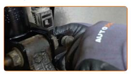
Den Halteclip des Bremsschlauchs anbringen. Benutzen Sie einen Hammer.
