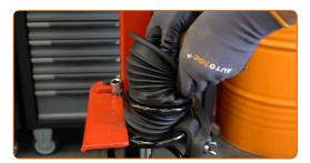
Ziehen Sie die Federbeinkolbenstangenmutter an. Verwenden Sie Inbusschlüssel Nr. H6. Verwenden Sie Stecknuss Nr. 21. Verwenden Sie einen Drehmomentschlüssel. Ziehen Sie ihn mit 65 Nm Drehmoment fest.
