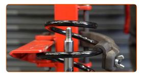
Bringen Sie das Stützlager, die Manschette und den Anschlagpuffer auf dem Stoßdämpfer an.
