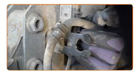
Trennen Sie die ABS Sensorverdrahtung.
