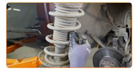
Stellen Sie das Dämpferbein auf das Federspannwerkzeug.
