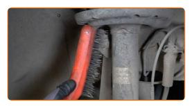
Schrauben Sie das Befestigungselement heraus, das die Druckstange mit dem Federbein verbindet. Verwenden Sie Ring-Gabelschlüssel Nr. 17. Verwenden Sie Stecknuss Nr. 18. Verwenden Sie einen Ratschenschlüssel.
