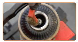
Entfernen Sie die Stangenmutter des Federkolben. Verwenden Sie Inbusschlüssel Nr. H6. Verwenden Sie Stecknuss Nr. 21. Verwenden Sie einen Ratschenschlüssel.
