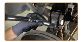
Verbinden Sie das ABS mit der Sensorverdrahtung.
