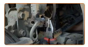
Lösen Sie den Bremsschlauch vom Federbein.
