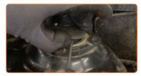
Entfernen Sie die Befestigungsklammer des oberen Domlagers. Verwenden Sie einen flachen Schraubendreher.
