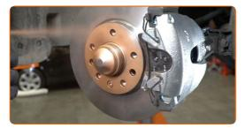
Die Bremsscheibenoberfläche reinigen. Benutzen Sie einen Bremsenreiniger.
