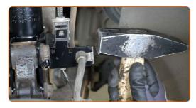
Montieren Sie den Querlenker.
