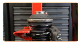
Entfernen Sie das zusammengebaute Federbein.
