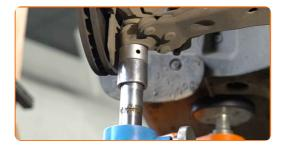
Entfernen Sie die Kappe des Federbeinstützlagers.
