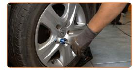
Entfernen Sie den Wagenheber sowie die Unterlegkeile.
