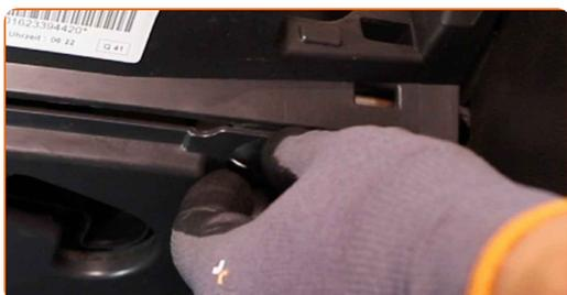
**8** Entfernen Sie die Abdeckung unter dem Handschuhfach.
