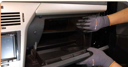
**19** Schrauben Sie die Befestigungsschrauben des Handschuhfaches fest. Verwenden Sie den Torx T20.
