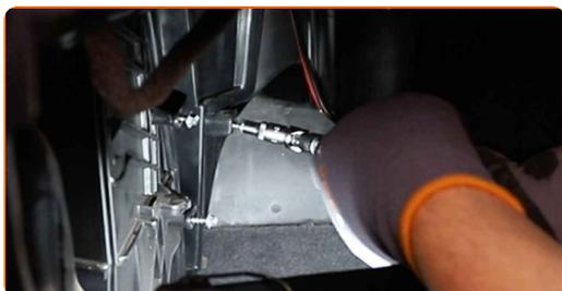
**15** Setzen Sie die Abdeckung unter dem Handschuhfach ein und befestigen Sie diese.
