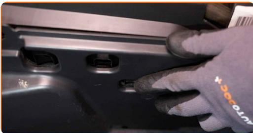
**16** Schrauben Sie die Befestigungen der Einstiegsverkleidung im Fahrgastbereich ein.
