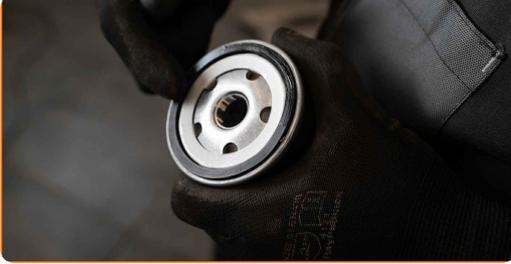
**16** Schrauben Sie den neuen Filter in seinen Platz. Verwenden Sie Steckschlüssel 76/14-F. Halten Sie das empfohlene Anzugsdrehmoment ein.
