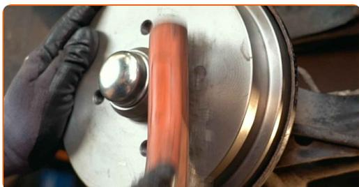
**39** Behandeln Sie die Oberfläche, an der die Radfelge die Bremstrommel berührt. Benutzen Sie ein Kupferschmiermittel.
