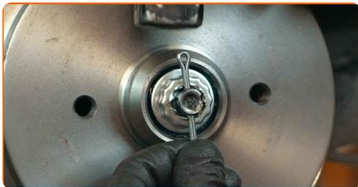
**37** Installieren Sie die Kappe der Nabenmutter. Benutzen Sie einen Hammer.
