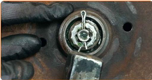
**11** Schrauben Sie die Nabenmutter ab. Verwenden Sie Stecknuss Nr. 24. Verwenden Sie einen Ratschenschlüssel.
