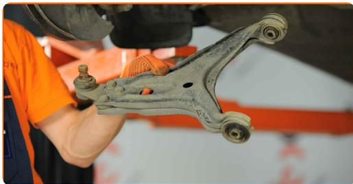
**15** Lösen Sie das Befestigungselement, welches das Kugelgelenk am Federungsquerlenker befestigt. Verwenden Sie Ring-Gabelschlüssel Nr. 17. Verwenden Sie Stecknuss Nr. 17. Verwenden Sie einen Ratschenschlüssel.
