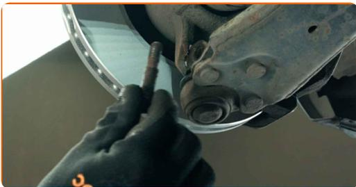
**9** Schrauben Sie die vordere Armbefestigung ab. Verwenden Sie Ring-Gabelschlüssel Nr. 17 (2 Teile).
