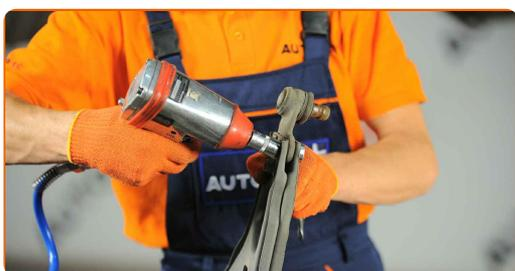
**16** Entfernen Sie das Kugelgelenk. Verwenden Sie einen Gummi-Hammer.
