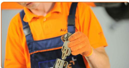
**17** Verbinden Sie das Kugelgelenk mit dem Lenker. Verwenden Sie einen Gummi-Hammer. Verwenden Sie einen flachen Schraubendreher.
