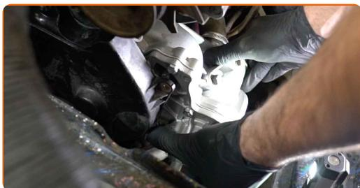
**26** Schrauben Sie die Befestigungen der Wasserpumpe fest. Verwenden Sie Ring-Gabelschlüssel Nr. 13. Verwenden Sie Stecknuss Nr. 13. Verwenden Sie einen Drehmomentschlüssel. Ziehen Sie ihn mit 14 Nm Drehmoment fest.
