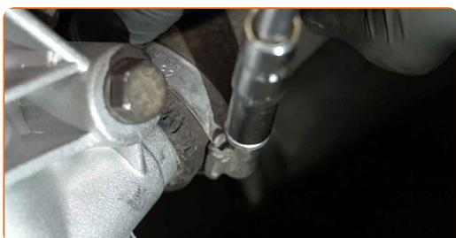
**29** Installieren Sie die Wasserpumpenriemenscheibe.
