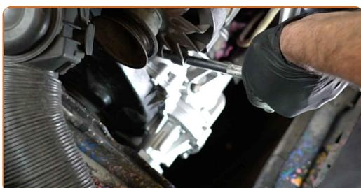
**27** Bringen Sie den Kühlmittelschlauch an.
