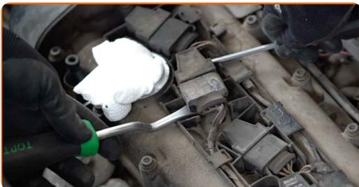
**10** Lösen Sie die Plastiksperrnasen des Zündspulensteckers. Verwenden Sie einen flachen Schraubendreher.
