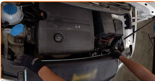
**3** Trennen Sie den Kurbelgehäuse-Entlüftungsschlauch von der Motorhaube zur Linken.
