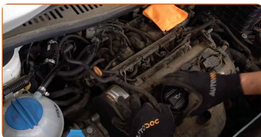
**7** Schrauben Sie den Öleinfüllstutzen heraus. Entfernen Sie den Öleinfüllstutzen.
