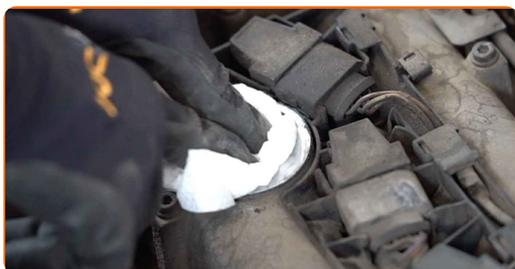
**9** Heben Sie die Zündspule an. Benutzen Sie ein Brecheisen. Verwenden Sie einen flachen Schraubendreher.
