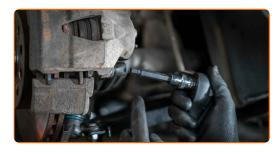
16 Entfernen Sie den Bremssattel.
