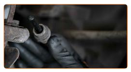
Entfernen Sie das alte Schmiermittel und Rückstände von Rost, falls es diese gibt, vom Bremssattel, den Bremssattelführungsbolzen sowie den Schutzhüllen. Benutzen Sie einen Bremsenreiniger.
