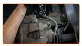
Schrauben Sie den Bremsschlauch vom Bremssattel ab. Verwenden Sie Ring-Gabelschlüssel Nr. 11. Bewegen Sie die Bremsschläuche zur Seite. Befestigen Sie die Bremsschläuche mit Hilfe eines Hakens oder eines Stück Drahts an der Karosserie.
