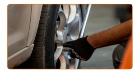
Entfernen Sie den Wagenheber sowie die Unterlegkeile.
