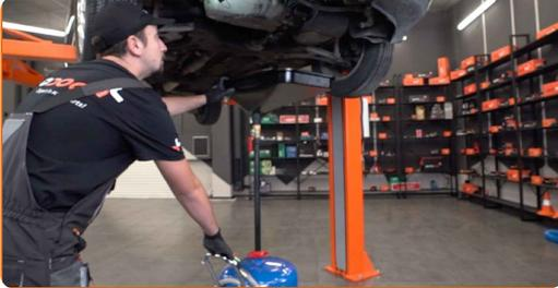
**7** Drehen Sie die Ablassschraube heraus. Verwenden Sie Stecknuss Nr. 19 oder Ringschlüssel Nr. 19.
