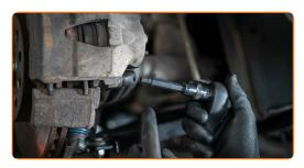
16 Entfernen Sie den Bremssattel.
