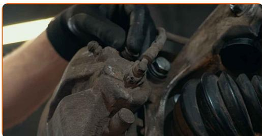
**23** Bauen Sie die Bremssattel-Haltefeder ein. Benutzen Sie ein Brecheisen.
