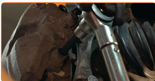
**22** Installieren Sie die Staubschutzkappen der Bremssattel-Führungsstifte.
