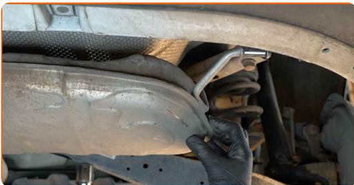
**13** Entfernen Sie die Befestigungsschraube.
