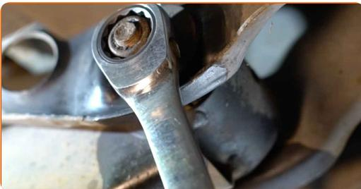
**12** Entfernen Sie das Befestigungselement der Auspuffanlage. Benutzen Sie ein Brecheisen.
