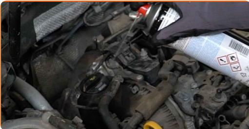
**4** Reinigen Sie den Deckel des Ölfilter-Gehäuses. Verwenden Sie Allzweckreinigungsspray.
