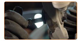
Schrauben Sie die Befestigungen des unteren Arms ab. Verwenden Sie Ring-Gabelschlüssel Nr. 16. Verwenden Sie Stecknuss Nr. 16. Verwenden Sie einen Ratschenschlüssel.
