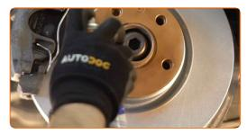
Die Bremsscheibenoberfläche reinigen. Benutzen Sie einen Bremsenreiniger.
