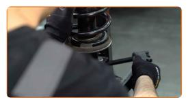
Installieren Sie das Federbein am Radlauf.
