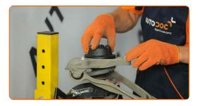
Ziehen Sie die Federbeinkolbenstangenmutter an. Verwenden Sie Stecknuss Nr. 18. Verwenden Sie einen Ratschenschlüssel. Verwenden Sie einen Drehmomentschlüssel. Ziehen Sie ihn mit 50 Nm Drehmoment fest.
