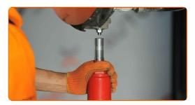
Ziehen Sie die untere Befestigung des Stoßdämpfers an. Verwenden Sie Ring-Gabelschlüssel Nr. 18. Verwenden Sie Stecknuss Nr. 18. Verwenden Sie einen Drehmomentschlüssel. Ziehen Sie ihn mit 90 Nm Drehmoment fest.
