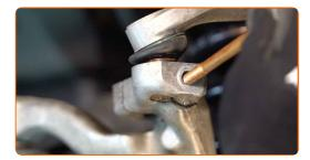
Ziehen Sie die Befestigung des oberen Arms an. Verwenden Sie Ring-Gabelschlüssel Nr. 16. Verwenden Sie Stecknuss Nr. 16. Verwenden Sie einen Drehmomentschlüssel. Ziehen Sie ihn mit 40 Nm Drehmoment fest.
