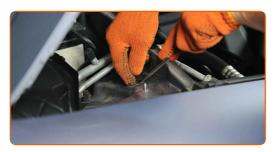
Schrauben Sie das obere Befestigungselement des Federbeins ab. Verwenden Sie Stecknuss Nr. 16. Verwenden Sie einen Ratschenschlüssel.
