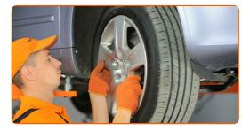
Reinigen Sie die Federbein-Befestigungselemente. Benutzen Sie eine Drahtbürste. Benutzen Sie WD-40-Spray.
