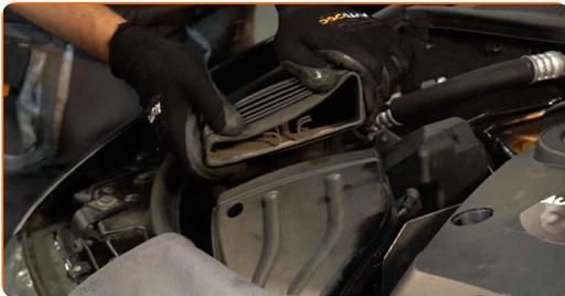
**4** Lösen Sie die Befestigungsschrauben der Luftfilter-Abdeckung. Verwenden Sie einen Kreuzschlitzschraubendreher.
