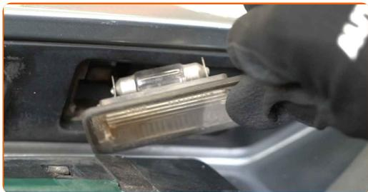
**5** Behandeln Sie die Steckverbinder der Kennzeichenleuchte. Verwenden Sie dielektrisches Fett. Verwenden Sie einen flachen Schraubendreher.
