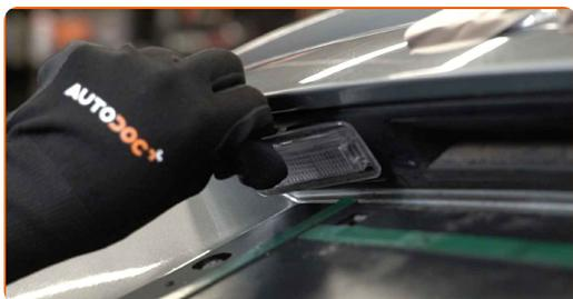
**7** Schrauben Sie die Befestigung des Gehäuses der Kennzeichenleuchte ein. Verwenden Sie einen Kreuzschlitzschraubendreher.
