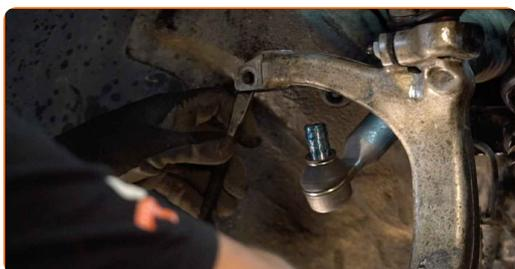
**18** Bauen Sie den Spurstangenkopf an dem Achsschenkel an.
