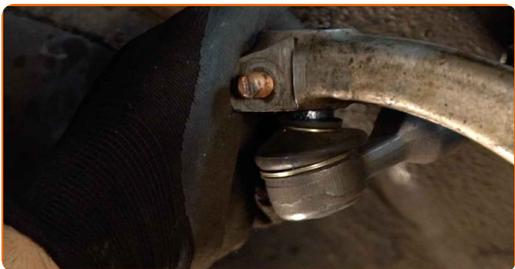
**20** Schrauben Sie die Befestigungsmutter auf, die den Spurstangenkopf mit dem Achsschenkel verbindet. Verwenden Sie Stecknuss Nr. 13. Verwenden Sie einen Ratschenschlüssel.
