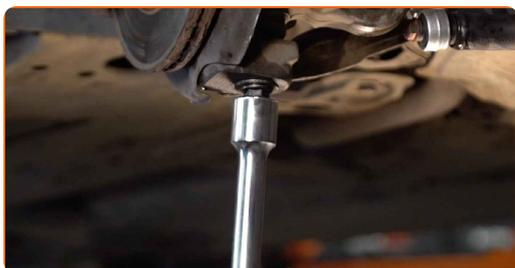
**14** Ziehen Sie das Befestigungselement an, das die Druckstange mit dem Stabilisator verbindet. Verwenden Sie Ring-Gabelschlüssel Nr. 16. Verwenden Sie Stecknuss Nr. 16. Verwenden Sie einen Drehmomentschlüssel. Ziehen Sie ihn mit 40 Nm Drehmoment fest.+90°
