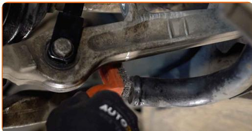
**12** Bringen Sie eine neue Stange an, ziehen Sie die Schrauben fest. Verwenden Sie Ring-Gabelschlüssel Nr. 16.
