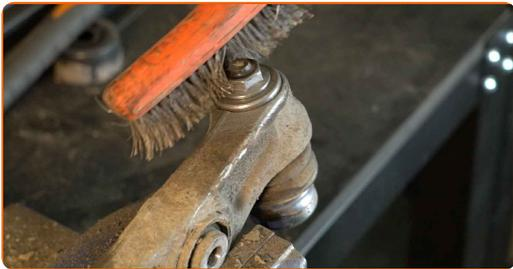
**19** Lösen Sie das Befestigungselement, welches das Kugelgelenk am Federungsquerlenker befestigt. Verwenden Sie Stecknuss Nr. 21. Verwenden Sie einen Ratschenschlüssel.
