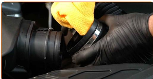
**15** Verbinden Sie das Luftansaugrohr mit dem Luftfilter-Gehäuse.
