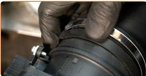
**6** Lösen Sie die Befestigungsschrauben der Luftfilter-Abdeckung. Verwenden Sie den Torx T30. Verwenden Sie einen Ratschenschlüssel.
