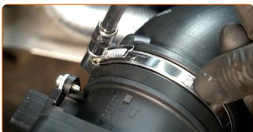
**5** Trennen Sie das Luftansaugrohr vom Luftfilter-Gehäuse.
