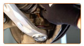
Bringen Sie die Befestigungsschraube an. Verwenden Sie Ring-Gabelschlüssel Nr. 21.
