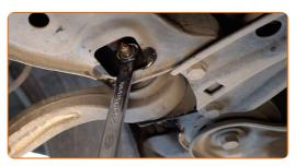
Entfernen Sie die Befestigungsschraube. Benutzen Sie ein Brecheisen.
