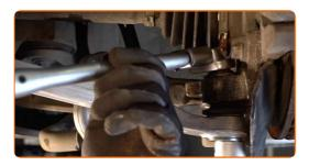
Entfernen Sie den Träger unter dem Arm.
