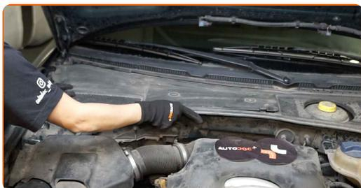
**12** Bauen Sie die Dichtung der Windabweiserabdeckung ein.
