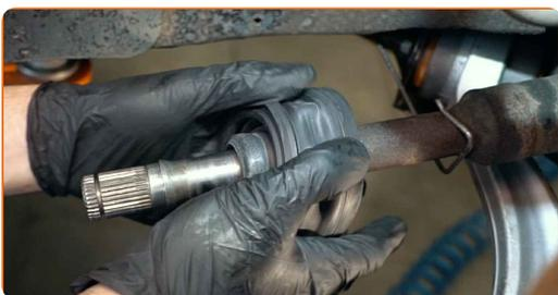
**37** Bringen Sie den Sicherungsring am Gleichlaufgelenk an.
