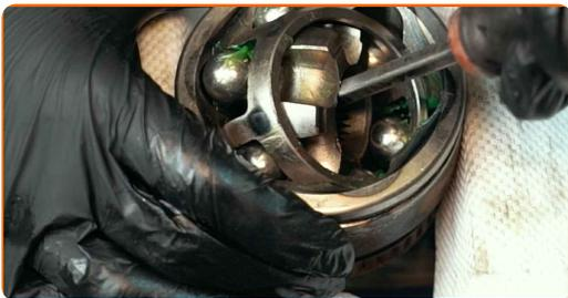
**33** Lösen Sie den Schraubstock und entfernen Sie das Gleichlaufgelenk.
