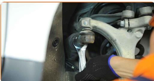
**12** Ziehen Sie den Spurstangenkopf vom Achsschenkel. Verwenden Sie einen flachen Metallmeißel. Benutzen Sie einen Hammer.
