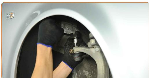
**19** Ziehen Sie die Befestigungsmutter an, die den Spurstangenkopf mit dem Achsschenkel verbindet. Verwenden Sie Stecknuss Nr. 16. Verwenden Sie einen Drehmomentschlüssel. Ziehen Sie ihn mit 45 Nm Drehmoment fest.
