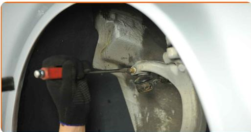
**10** Beim Deinstallieren sollten Sie die genaue Position des Kugelgelenks an der Spurstange markieren oder messen - oder zählen Sie die Anzahl der Windungen, um danach eine Fehlausrichtung zu vermeiden. Verwenden Sie einen Messschieber.
