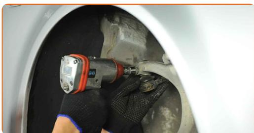
**9** Entfernen Sie die Befestigungsschraube. Verwenden Sie einen flachen Metallmeißel. Benutzen Sie einen Hammer.
