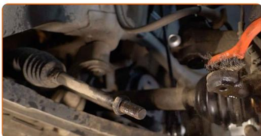
**15** Schrauben Sie einen neuen Spurstangenkopf an.
