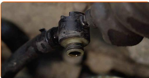
17 Befestigen Sie die Leitung am Kraftstofffilter.
