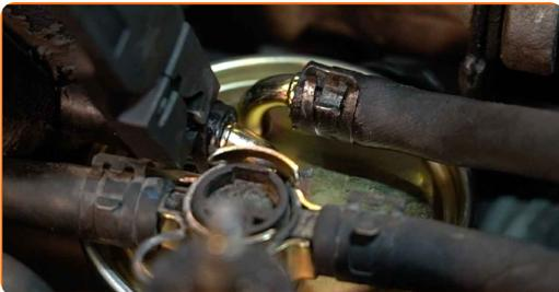
20 Ziehen Sie die Befestigungsklemme der Kraftstofffilterleitung an. Verwenden Sie Schlauchklemmzangen mit Arretierung.
