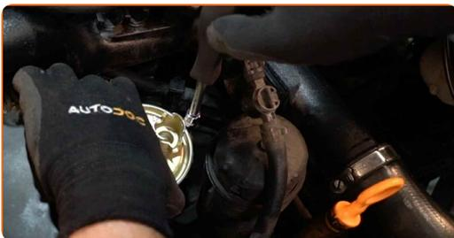
**15** Entfernen Sie die O-Ringe. Verwenden Sie einen flachen Schraubendreher.
