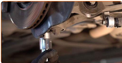
**13** Ziehen Sie das Befestigungselement an, das die Druckstange mit dem Stabilisator verbindet. Verwenden Sie Ring-Gabelschlüssel Nr. 16. Verwenden Sie Stecknuss Nr. 16. Verwenden Sie einen Drehmomentschlüssel. Ziehen Sie ihn mit 40 Nm Drehmoment fest.+90°
