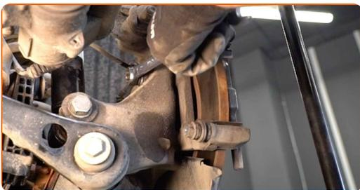
**13** Entfernen Sie die Sattelhalterung.
