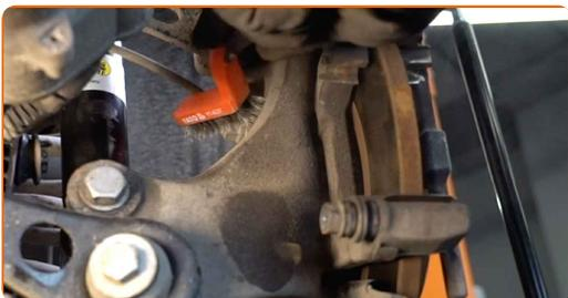
**12** Lösen Sie die Befestigung der Sattelhalterung. Verwenden Sie Ring-Gabelschlüssel Nr. 17.
