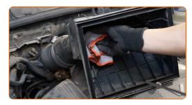
Reinigen Sie die Abdeckung und das Gehäuse des Luftfilters.
