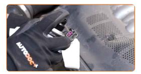
Bringen Sie den Steckverbinder des Luftmassenmessers an.
