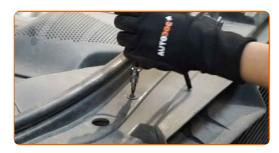
5 Entferne die Komponenten des Lüftungskanals.
