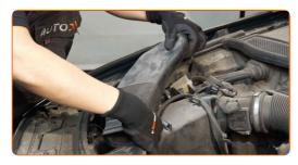
6 Lösen Sie den Steckverbinder des Luftmassenmessers.
