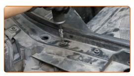
Bauen Sie die Abdeckung des Luftfiltergehäuses ein.
