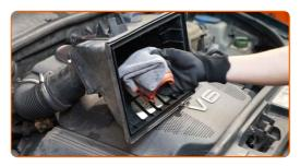
Setzen Sie ein neues Filterelement in das Filtergehäuse. Stellen Sie sicher, dass die Filterkante dicht am Gehäuse ansitzt.
