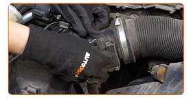
Setze die Komponenten des Lüftungskanals wieder ein.
