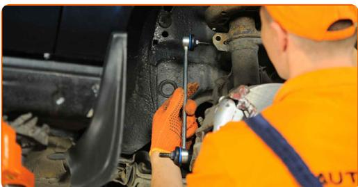
**12** Ziehen Sie das Befestigungselement an, das die Druckstange mit dem Stabilisator verbindet. Verwenden Sie Ring-Gabelschlüssel Nr. 16. Verwenden Sie Ring-Gabelschlüssel Nr. 17. Verwenden Sie einen Drehmomentschlüssel. Ziehen Sie ihn mit 40 Nm Drehmoment fest.
