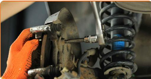
14 Entfernen Sie die Sattelhalterung.
