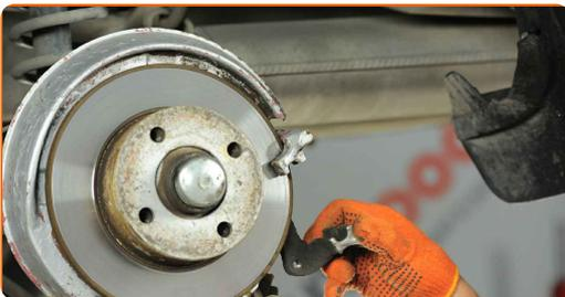
15 Entfernen Sie die Bremsscheibe.
