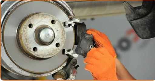
12 Die Befestigungselemente der Bremssattelhalterung reinigen. Benutzen Sie eine Drahtbürste. Benutzen Sie WD-40-Spray.
