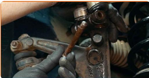
**18** Entfernen Sie die Querlenker.
