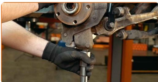
**15** Reinigen Sie alle Verbindungen des Querlenkers. Benutzen Sie eine Drahtbürste. Benutzen Sie WD-40-Spray.
