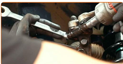
**17** Entfernen Sie die Befestigungsschraube.
