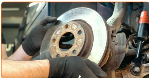
**13** Entfernen Sie die Befestigungsschraube. Verwenden Sie Inbusschlüssel Nr. H14. Verwenden Sie einen Ratschenschlüssel.
