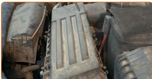
**5** Heben Sie die Abdeckung des Luftfiltergehäuses leicht an.
