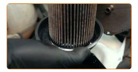
Pumpen Sie den Kraftstoff aus dem Kraftstofffiltergehäuse. Verwenden Sie eine manuelle Absaugpumpe.
