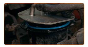
Entfernen Sie den Kraftstofffilter. Verwenden Sie einen flachen Schraubendreher.
