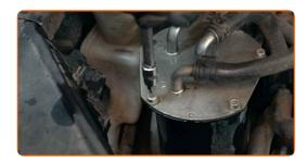
Schließen Sie das Diagnosegerät an und versetzen Sie die Kraftstoffanlage in den Betriebszustand. Dies ist nötig, damit sich die Kraftstoffanlage vollständig mit Kraftstoff füllt.
