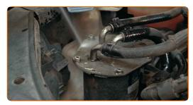
Schrauben Sie die Befestigungen vom Deckel des Kraftstofffiltergehäuses ab. Verwenden Sie den Torx T15. Verwenden Sie einen Ratschenschlüssel.
