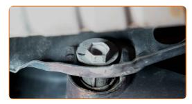
Schrauben Sie die Armbefestigung vom Balken ab. Verwenden Sie Ring-Gabelschlüssel Nr. 18. Verwenden Sie Stecknuss Nr. 18. Verwenden Sie einen Ratschenschlüssel.
