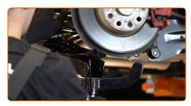
Ziehen Sie die Befestigungen an, die den Querlenker mit dem Hinterachsgelenk verbinden. Verwenden Sie Ring-Gabelschlüssel Nr. 18. Verwenden Sie Stecknuss Nr. 18. Verwenden Sie einen Drehmomentschlüssel. Ziehen Sie ihn mit 90 Nm Drehmoment fest.+90°
