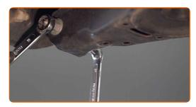
Entfernen Sie das Befestigungselement der Auspuffanlage.
