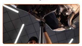
Bringen Sie das Befestigungselement der Auspuffanlage an.
