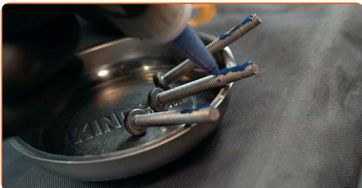
**54** Reinigen Sie die Montagesitze der Drosselklappe. Verwenden Sie Allzweckreinigungsspray.
