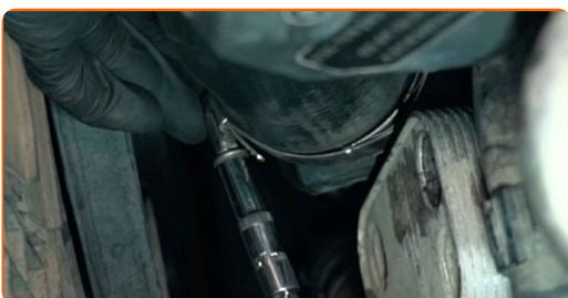
**62** Schließen Sie den Verbindungsstecker der Drosselklappe an.
