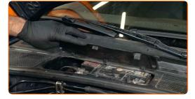
Schrauben Sie Befestigungen der Auto-Batterieklemmen heraus. Verwenden Sie Ring-Gabelschlüssel Nr. 10.
