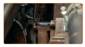
Schrauben Sie die Befestigung der Viskokupplung auf. Verwenden Sie Ring-Gabelschlüssel Nr. 46. Verwenden Sie Inbusschlüssel Nr. H8.
