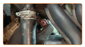
Schrauben Sie die Befestigung des Lichtmaschinenstromkabels ab. Verwenden Sie Ring-Gabelschlüssel Nr. 13.
