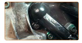
Schrauben Sie die Befestigungselemente des Thermostatgehäuses ab. Verwenden Sie Stecknuss Nr. 10. Verwenden Sie einen Ratschenschlüssel.
