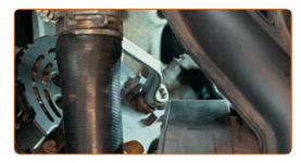
Reinigen Sie das Thermostatgehäuse. Verwenden Sie Allzweckreinigungsspray.
