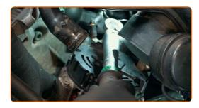
Bringen Sie den Verbindungsstecker der Lichtmaschine an.
