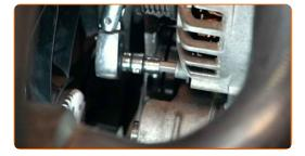
24 Entfernen Sie die Lichtmaschine.
