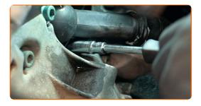
Entfernen Sie das Thermostatgehäuse.
