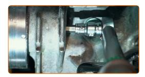
Ziehen Sie die Spannrolle des Keilrippenriemens beiseite. Verwenden Sie Ring-Gabelschlüssel Nr. 17.
