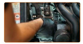
Schrauben Sie die Befestigungen der Lichtmaschine fest. Verwenden Sie Inbusschlüssel Nr. H8. Verwenden Sie einen Drehmomentschlüssel. Ziehen Sie ihn mit 8 Nm Drehmoment fest.
