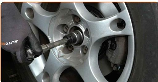
**5** Lockern Sie die Radschrauben. Verwenden Sie eine Schlagnuss für Felgen # 17. Verwenden Sie ein Windeisen.
