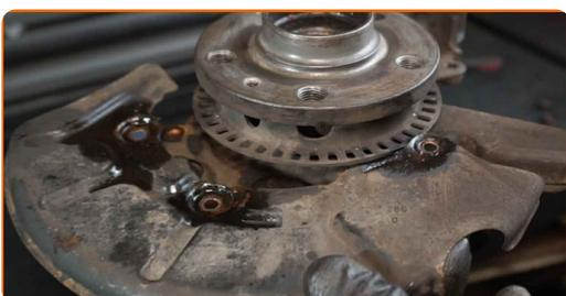
**39** Entfernen Sie die Radnabe vom Achsschenkel. Verwenden Sie einen Druckstücksatz mit Ein-/Auspresswerkzeug.
