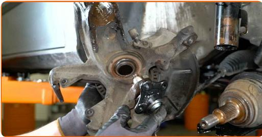
**35** Reinigen Sie die Befestigungen des Bremsenabdeckblechs. Benutzen Sie eine Drahtbürste. Benutzen Sie WD-40-Spray.
