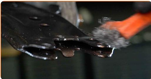
**53** Reinigen Sie die Befestigung des Spurstangenkopfes. Benutzen Sie eine Drahtbürste. Benutzen Sie WD-40-Spray.
