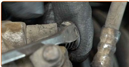
**11** Schrauben Sie die Befestigungen des Bremssattels ab. Verwenden Sie Inbusschlüssel Nr. H7. Verwenden Sie einen Ratschenschlüssel.
