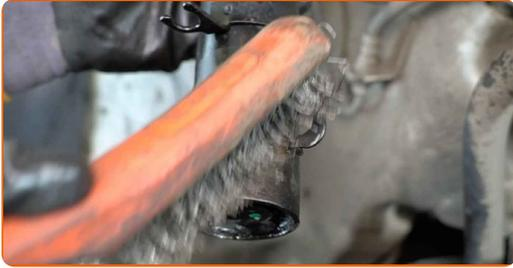
**50** Die Keilwellen des CV-Gelenks der Antriebswelle reinigen. Benutzen Sie eine Drahtbürste. Benutzen Sie WD-40-Spray.
