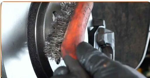
**87** Behandeln Sie die Oberfläche, an der die Bremsscheibe die Felge berührt. Verwenden Sie Keramikfett.
