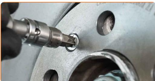
**75** Schrauben Sie die Befestigungen der Bremsscheibe fest. Verwenden Sie einen Kreuzschlitzschraubendreher. Verwenden Sie einen Drehmomentschlüssel. Ziehen Sie ihn mit 4 Nm Drehmoment fest.
