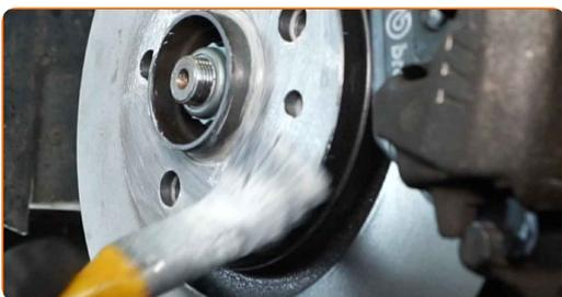
**88** Die Bremsscheibenoberfläche reinigen. Benutzen Sie einen Bremsenreiniger.
