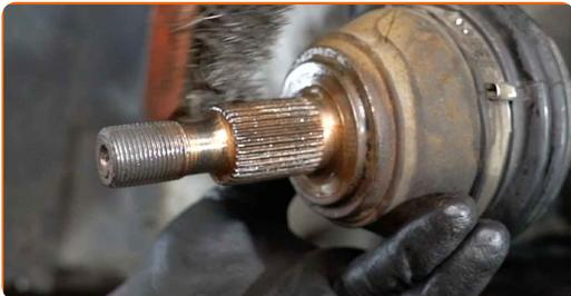
**51** Behandeln Sie die Keilwellen des Antriebswellen-Gleichlaufgelenks. Benutzen Sie ein Kupferschmiermittel.
