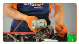
Installieren Sie einen neuen Kraftstofffilter.
