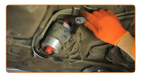
Befestigen Sie die Leitung am Kraftstofffilter.
