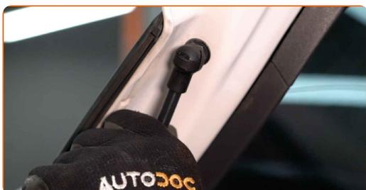
**10** Entfernen Sie den hydraulischen Getriebeheber.
