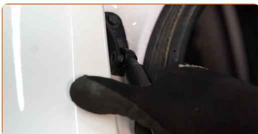
**9** Lassen Sie den Sprengring, der die Gasfeder mit der Karosserie verbindet, einrasten.
