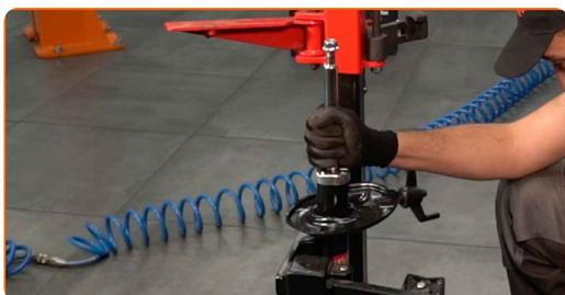
**31** Installieren Sie die Feder am Stoßdämpfer.
