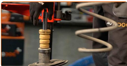
**29** Entnehmen Sie den alten Stoßdämpfer aus dem hydraulischen Spiralfederspanner.
