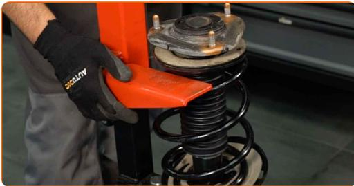
**38** Entfernen Sie das zusammengebaute Federbein.
