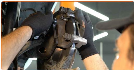
**32** Befestigen Sie die Bremssattelhalterung. Verwenden Sie Stecknuss Nr. 14. Verwenden Sie einen Drehmomentschlüssel. Ziehen Sie ihn mit 57 Nm Drehmoment fest.
