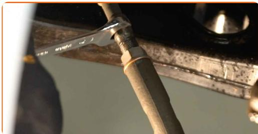
**16** Beim Deinstallieren sollten Sie die genaue Position des Kugelgelenks an der Spurstange markieren oder messen - oder zählen Sie die Anzahl der Windungen, um danach eine Fehlausrichtung zu vermeiden. Verwenden Sie einen Messschieber.
