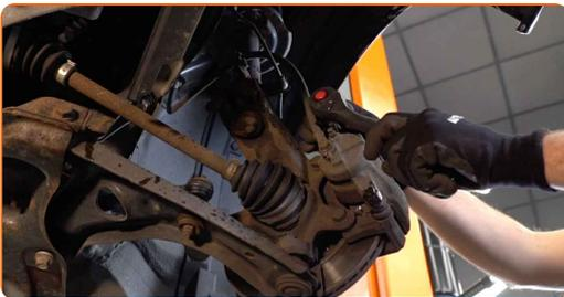
10 Entfernen Sie den Bremssattel.
