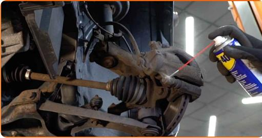
9 Schrauben Sie die Befestigung des Bremssattels ab. Verwenden Sie Stecknuss Nr. 13. Verwenden Sie einen Ratschenschlüssel.
