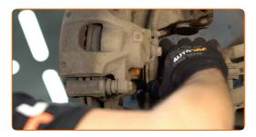
Verbinden Sie den Unterarm mit dem Achsschenkel. Benutzen Sie ein Brecheisen.
