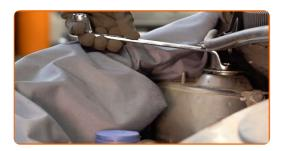
Reinigen Sie das Befestigungselement der Radnabe. Benutzen Sie WD-40-Spray. 4
