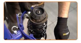
Entfernen Sie das zusammengebaute Federbein.
