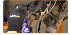
Befestigen Sie das Dämpferbein auf dem Achsschenkel.
