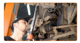
Ziehen Sie das Kugelgelenk an. Verwenden Sie Ring-Gabelschlüssel Nr. 19. Verwenden Sie einen Drehmomentschlüssel. Ziehen Sie ihn mit 98 Nm Drehmoment fest.
