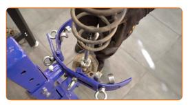
37 Installieren Sie die Feder am Stoßdämpfer.
