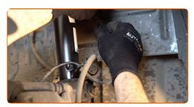
Ziehen Sie die unteren Befestigungen an, die das Federbein mit dem Achsschenkel verbinden. Verwenden Sie Stecknuss Nr. 17. Verwenden Sie einen Drehmomentschlüssel. Ziehen Sie ihn mit 52 Nm Drehmoment fest.
