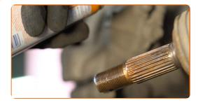
Die Antriebswelle in die Radnabe installieren.
