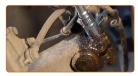
Entfernen Sie die Befestigungsschraube. 16
