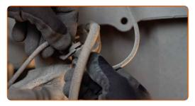
Reinigen Sie die Befestigungen des ABS-Sensors und des Bremsschlauchs, die diese mit dem Federbein verbinden. Die Befestigungselemente, die das Federbein mit dem Achsschenkel verbinden, reinigen. Benutzen Sie eine Drahtbürste. Benutzen Sie WD-40-Spray.
