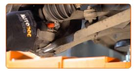
Entfernen Sie den Splint. Verwenden Sie eine Rundzange. 18
