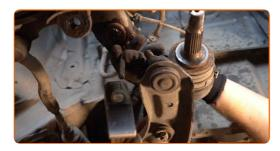
Entfernen Sie den Träger unter dem Achsschenkel.
