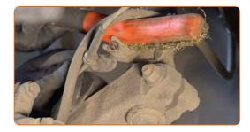
Schrauben Sie den Bremsschlauch-Befestigungswinkel aus dem Federbein heraus. Verwenden Sie Stecknuss Nr. 15.
