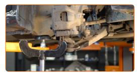
Ziehen Sie den unteren Arm vom Achsschenkel ab. Verwenden Sie einen Kugelgelenkabzieher. Benutzen Sie ein Brecheisen.
