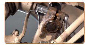
Ziehen Sie die Befestigungsklammer des Bremsschlauchs am Federbein an. Verwenden Sie Stecknuss Nr. 15.
