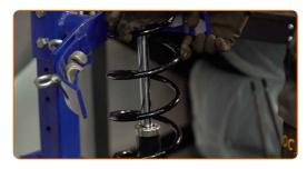
Installieren Sie die Manschette und eine Stoßstopp auf den Stoßdämpfer.
