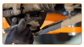
Stützen Sie die Achsschenkel auf. Benutzen Sie einen hydraulischen Getriebeheber.
