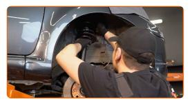
Schrauben Sie die obere Befestigung des Federbeinbefestigung an. Schrauben Sie diese nicht fest.
