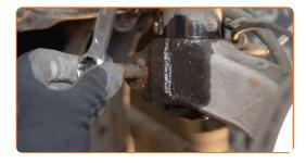
Reinigen Sie alle Verbindungen des Querlenkers. Benutzen Sie eine Drahtbürste. Benutzen Sie WD-40-Spray. 17
