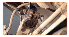
Schrauben Sie das Befestigungselement ein, das das Federbein mit dem Achsschenkel verbindet. Verwenden Sie Stecknuss Nr. 17. Verwenden Sie Ring-Gabelschlüssel Nr. 17.
