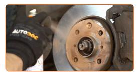
Die Bremsscheibenoberfläche reinigen. Benutzen Sie einen Bremsenreiniger.
