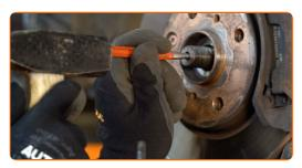
Lösen Sie das untere Befestigungselement, dass das Federbein mit dem Achsschenkel verbindet. Verwenden Sie einen flachen Metallmeißel. Benutzen Sie einen Hammer.
